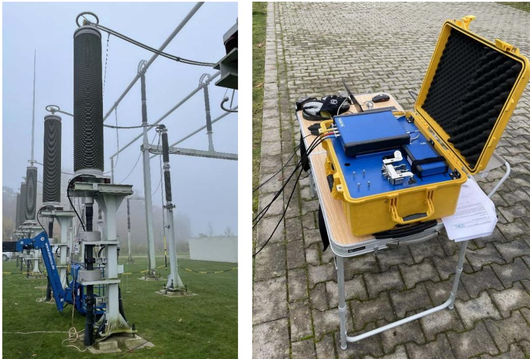
Abbildung 115: Messleitungen am Kabelendverschluss (links); Messsystem: Omicron FRANEO 800 (rechts)
